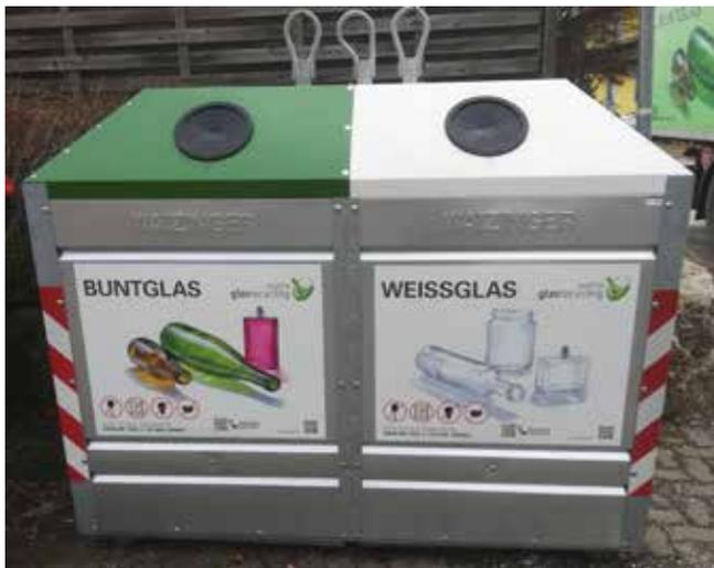
Zur Entleerung wird der gesamte Behälter über den Sammel-LKW gehoben. Die Bodenklappen können danach einzeln geöffnet werden. Da der Laderaum mit einer Zwischenwand abgetrennt ist, werden die zwei Altglassorten auch nicht vermischt. Das Weißglas fällt anschließend in den Weißglas, das Buntglas in den Buntglasbereich des LKWs.
